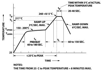
T<sub>smax</sub> = 200°C, T<sub>smin</sub> = 150°C
